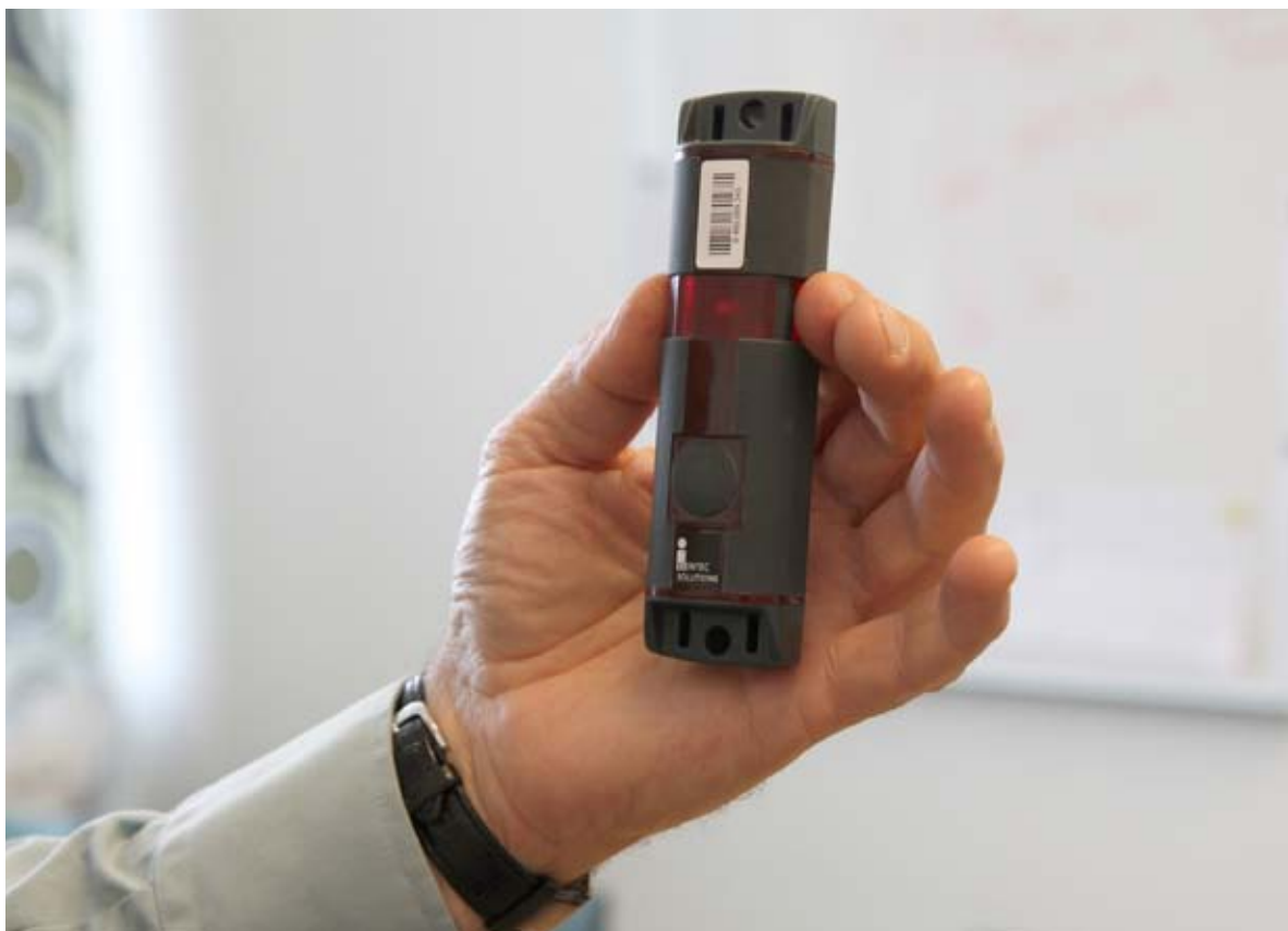
Taggen som ska bäras i fickan innehåller en radioutrustning som skickar signaler till de olika läsplatserna i gruvan.
