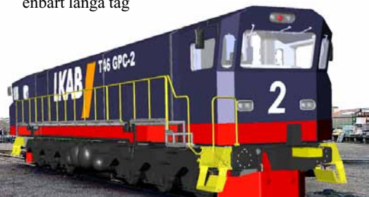
Terminalloken av typ T46 levererades 1974 och har byggts om för att de skulle klara att dra de nya tågsätten och för att förbättra utsläppsnivåer och arbetsmiljö.
