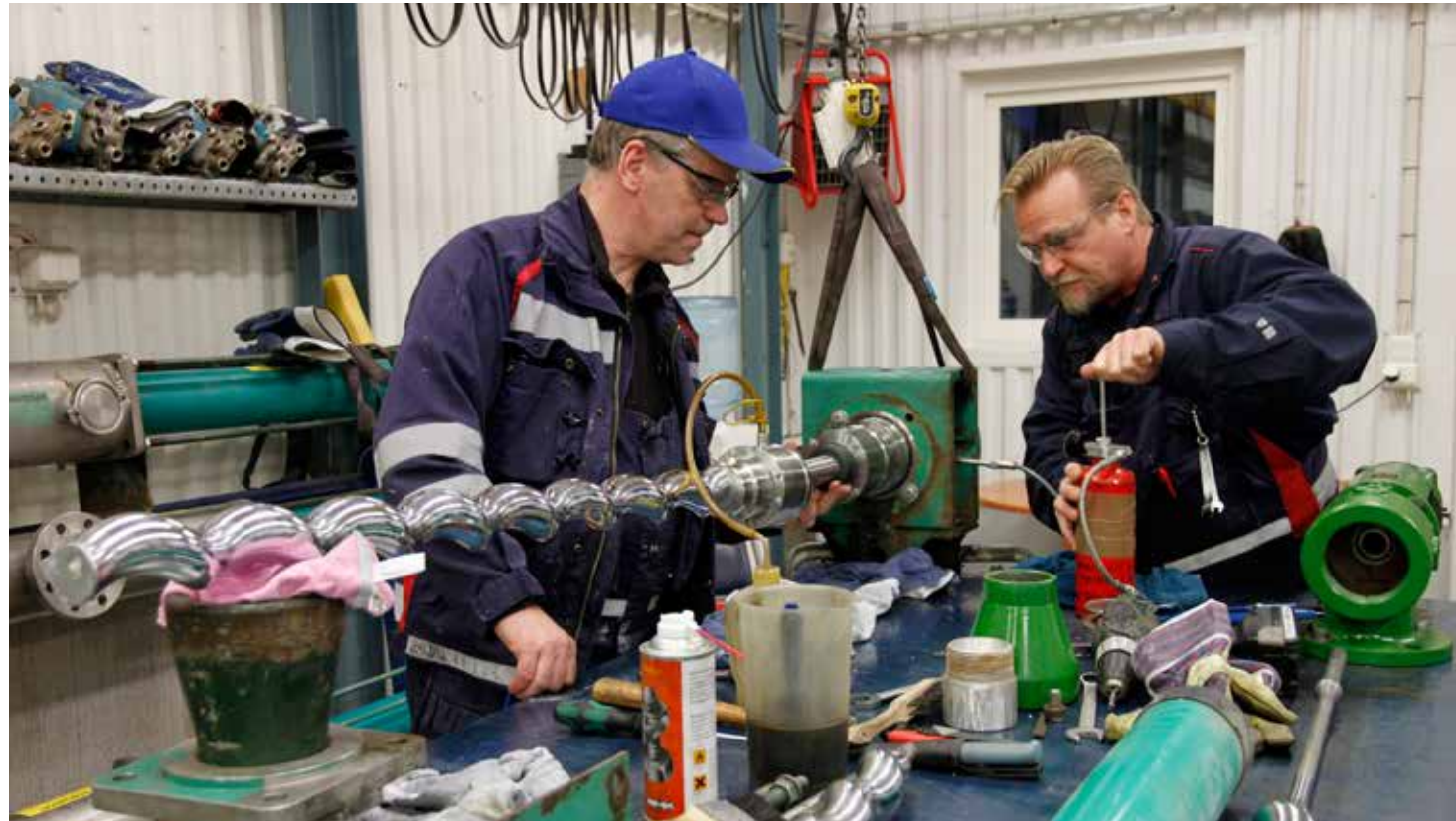
Rolf Tornéus och Christer Henriksson, reparatörer på LKAB Kimit, utför underhåll på en pump till en laddbil. Alla pumpar kommer in för underhåll efter 12 månader oavsett skick, och för säkerhetens skull.
